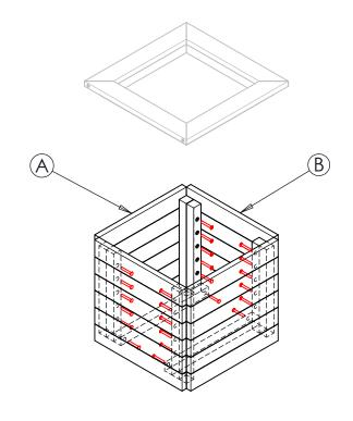
SCREW 20 x 70mm SCREWS THROUGH CORNER JOISTS IN SIDE (B) INTO CORNER JOISTS IN SIDE (A)
